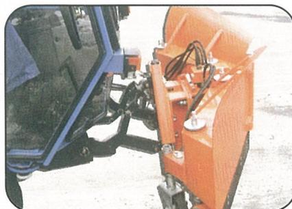
Pala delantera hidráulica con regulación de la altura.
