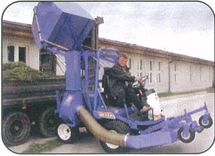
Saco recogedor con descarga hidráulica en altura con un volumen de 1.000 litros y 2,20 metros de altura.
