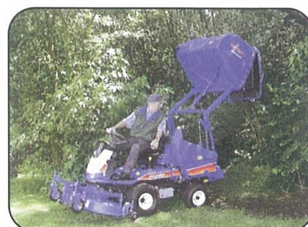
Saco recogedor descarga hidráulica en altura con 500 litros capacidad de saco, descargando a 1,80 metros de altura.
